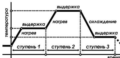
Ввод программы заключается в последовательном указании значений температуры выдержки, времени выдержки и скорости нагрева или охлаждения для каждой ступени видимой программы. Для корректировки параметров ступени необходимо выполнить следующие действия:
